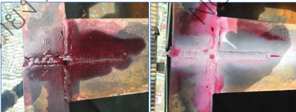
รูปที่ 8 ผลการทดสอบความสมบูรณ์ของรอยเชื่อม
