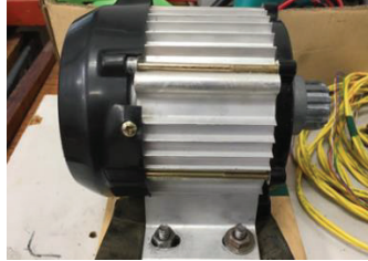
รูปที่ 4 มอเตอร์ไฟฟ้ากระแสตรงไร้แปรงถ่านสามเฟส 48 โวลต์
