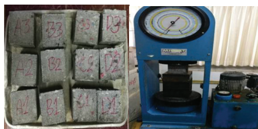
รูปที่ 4 ทดสอบความต้านแรงอัดของอิฐบล็อก
