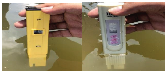
รูปที่ 5 บันทึกผลการเปลี่ยนแปลงของค่า pH และวัดทดสอบค่าคุณภาพของน้ำ
